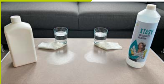
Küchenpapier wird mit jeweiliger Reinigungslösung getränkt und mit dem Glas beschwert.
